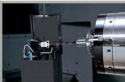
Устройство автоматического измерения длины инструмента с датчиком
