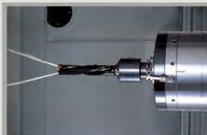
Система подачи СОЖ через шпиндель
