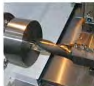
Сверло со сменными пластинами типа U-drill (63 мм) Углеродистая сталь - Ст. 45 (SM45C)
