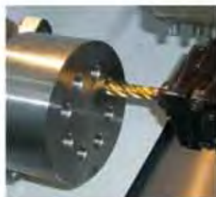
Нарезание резьбы Углеродистая сталь - Ст. 45 (SM45C)
