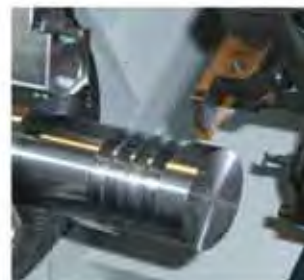
Нарезание канавок Углеродистая сталь - Ст. 45 (SM45C)
