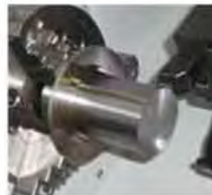
Наружная обработка Углеродистая сталь - Ст. 45 (SM45C)
