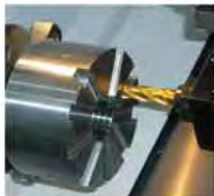
Торцевое фрезерование Углеродистая сталь - Ст. 45 (SM45C)
