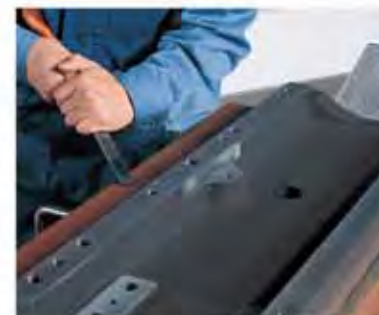
Шабрение поверхности направляющих скольжения
